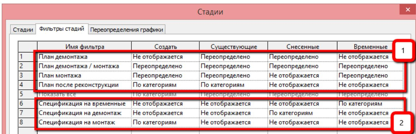
1. Фильтры стадий, настроенные для оформления видов в проекте реконструкции - планов, фасадов, разрезов и проч.
