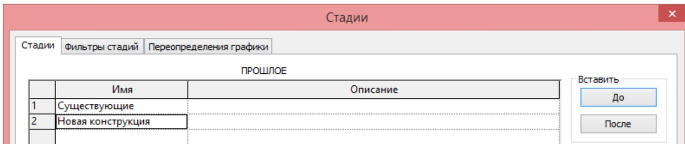
Чтобы построить элемент на конкретной стадии, нужно до его создания настроить вид, на котором вы будете выполнять построение: установить конкретную стадию, например, «Существующие» (по умолчанию установлена стадия «Новая конструкция»). Так, если установить стадию «Существующие», все новые элементы будут создаваться на стадии «Существующие», и т.п.
